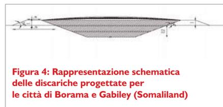
**Figura 4: Rappresentazione schematica delle discariche progettate per le città di Borama e Gabiley (Somaliland)**
